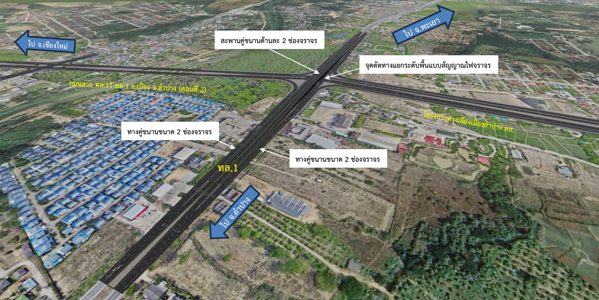
รูปแบบที่ 1 : สะพานข้ามแยก (Flyover Bridge) ในแนว ทล.1 แบบ 2 ทิศทาง + จุดตัดทางแยกระดับพื้นปรับปรุงเป็นแยกสัญญาณไฟจราจร
